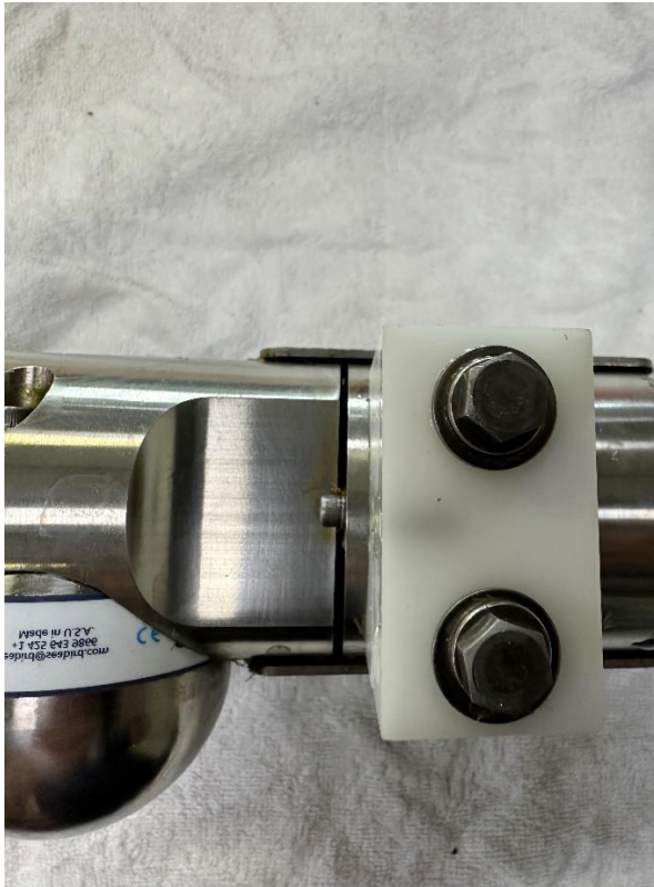
Flooded SBE 37 ODO SN: 23950 Loose sensor.
