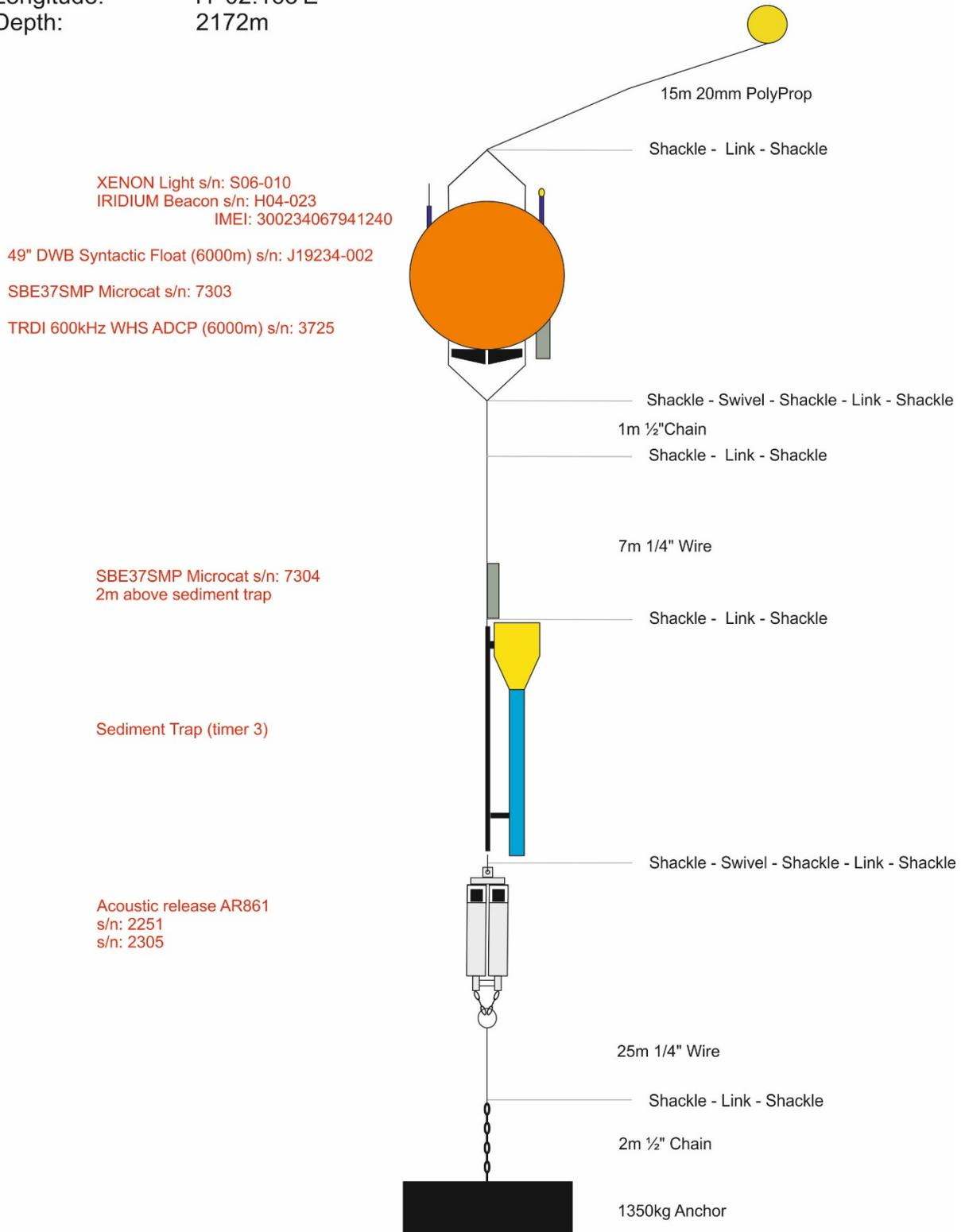
Figure 8.7. Diagram of NERC Mooring-9.
