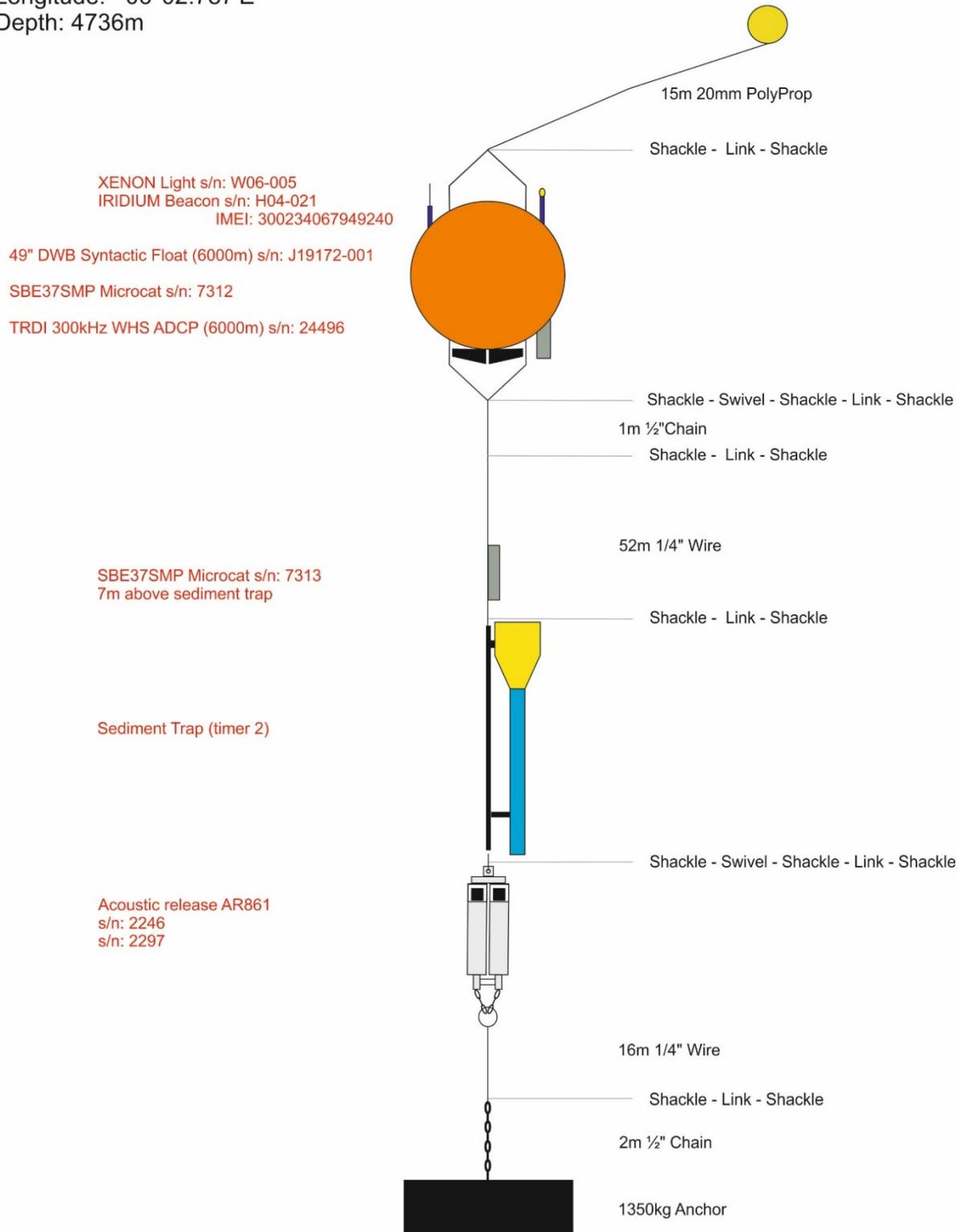
Figure 8.2. Diagram of NERC Mooring-7.
