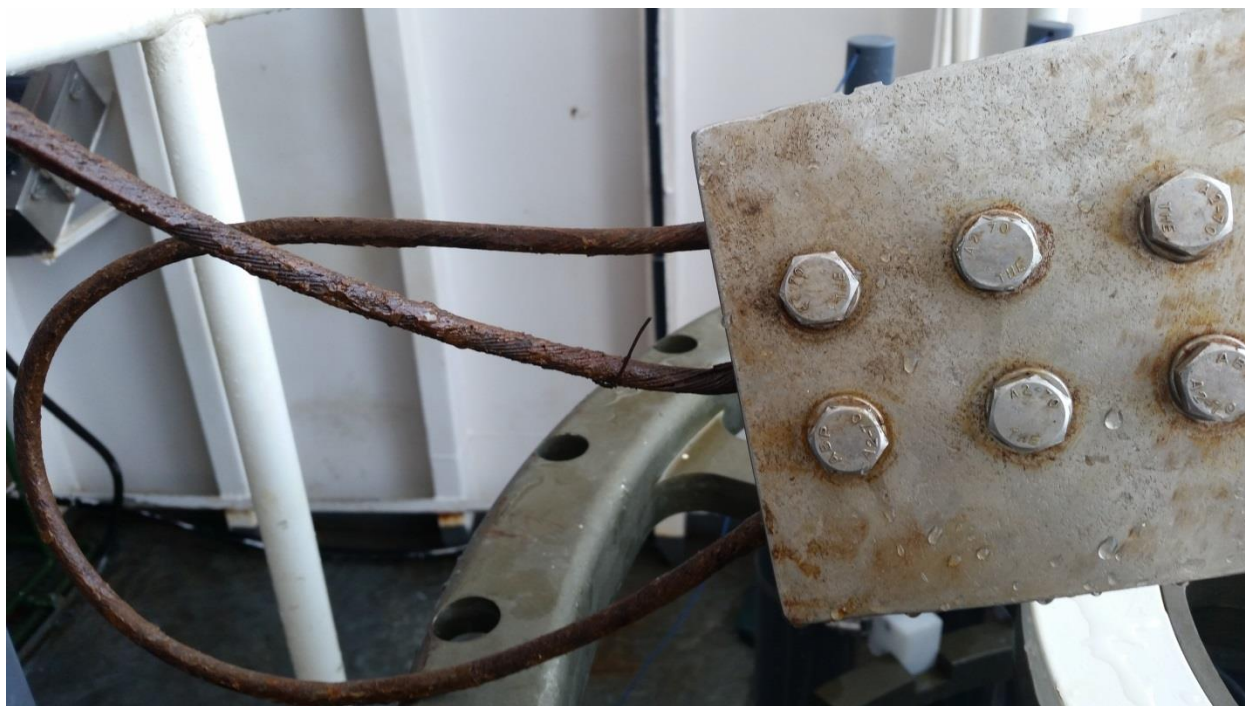
Figura 3: Cabo eletromecânico do CTD rompido próximo ao “sanduíche”.
