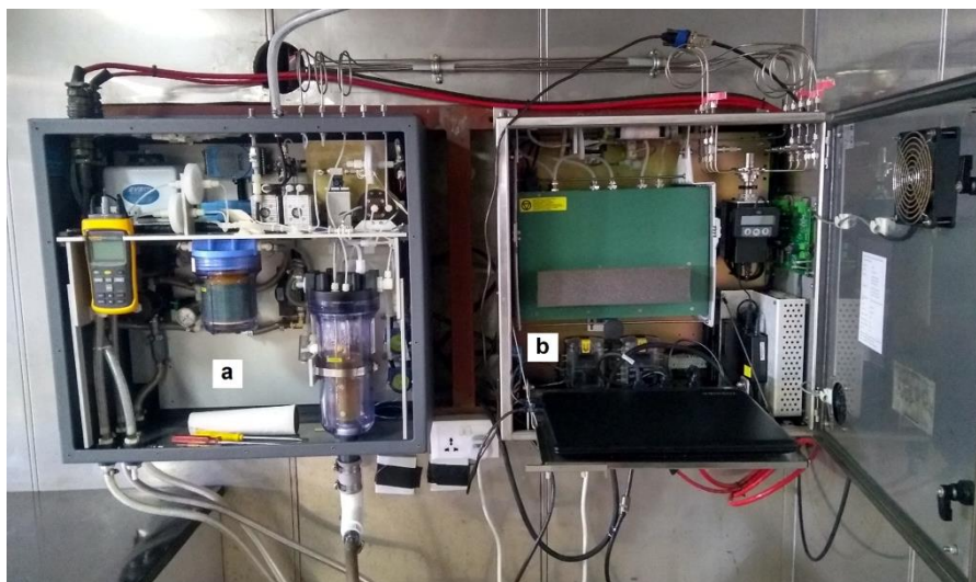
Figura 8: a) Wet box ; b) Dry box .
