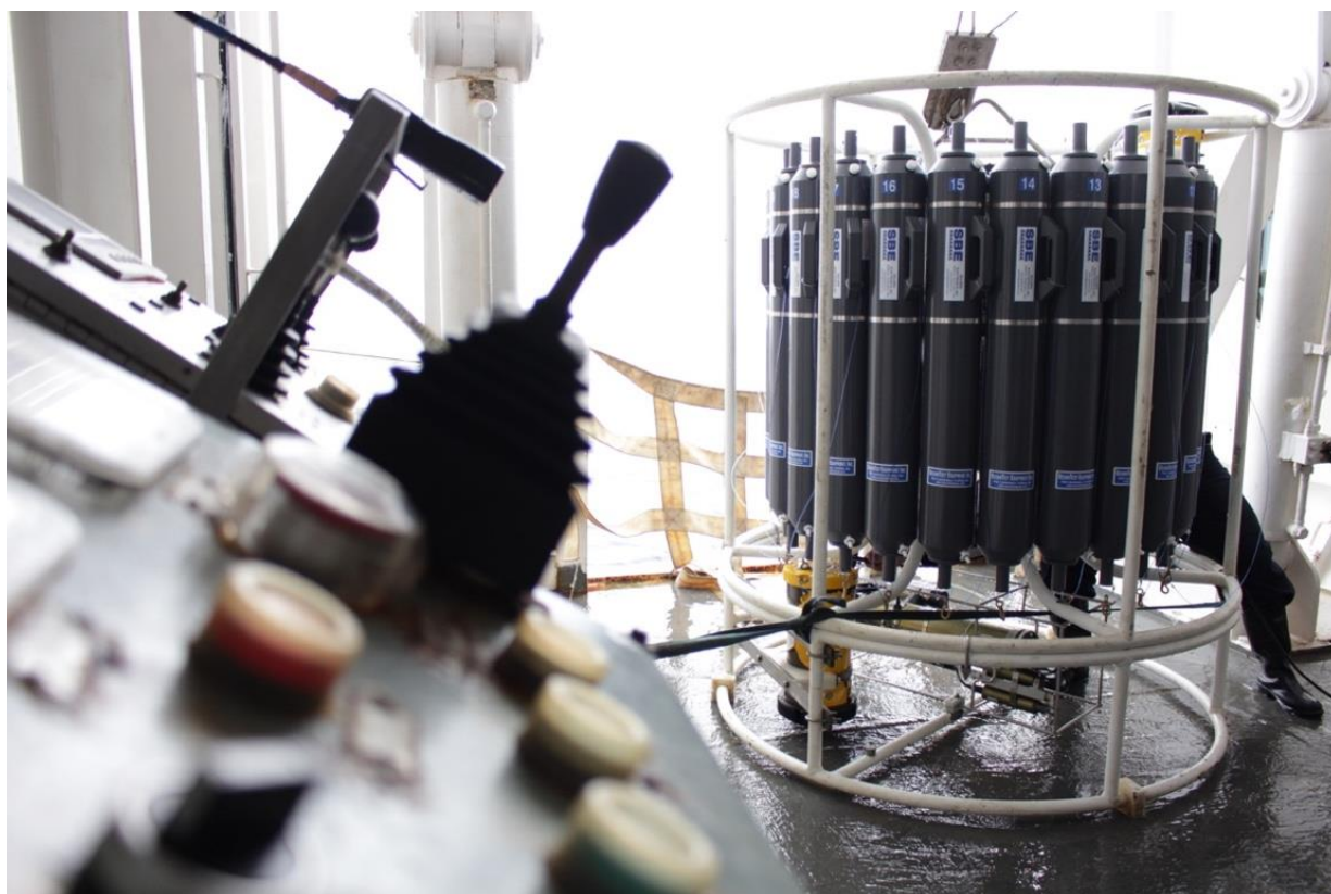
Figura 4: Sistema CTD/Rosette. Foto: Caio Costa / UFC.
